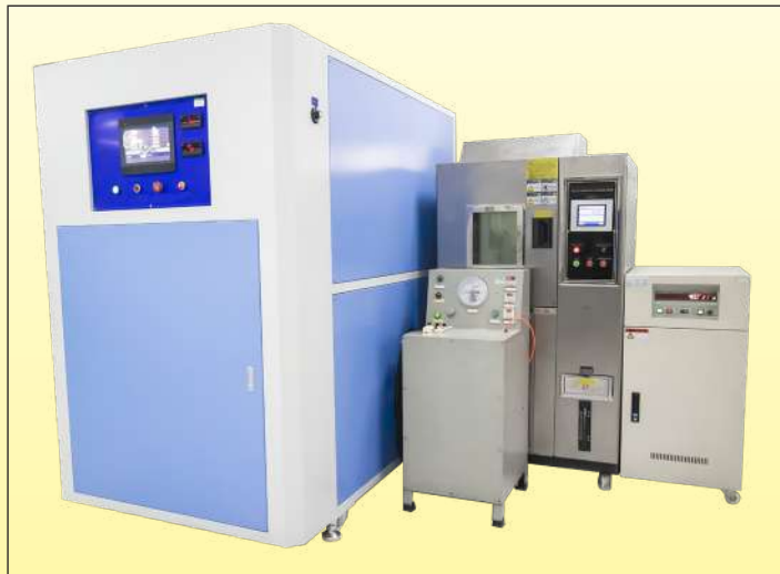
Elektrische Lebensdauer-Prüfgeräte für Druckschalter (Dient zur Überprüfung der Einhaltung der geltenden UL- und CE-Normen)
